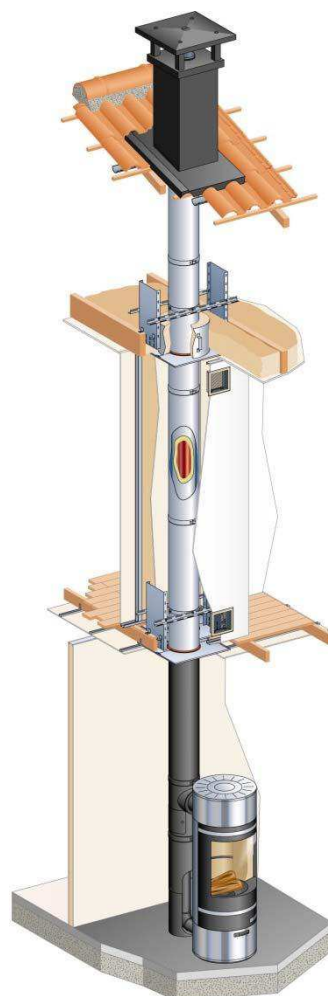
Figure 6b – Montage en traversée d'étage
