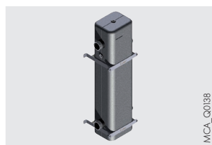
Bouteille de découplage 60/60 - 1" - Colis GV 45 Pour toutes les installations avec plusieurs circuits (1 circuit direct + 1 circuit vanne) ou pour les installations en cascade jusqu'à 70 kW, l'utilisation d'une bouteille de découplage est fortement recommandée.
