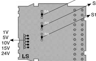
Il est possible de sélectionner l'état des sorties pour obtenir une modalité directe ou inverse. Les cavaliers S1, S2 et S3 sont normalement fermés en position A; pour charger leur état; il est nécessaire de retirer la connexion présente. Seul un personnel technique formé peut exécuter cette opération.
