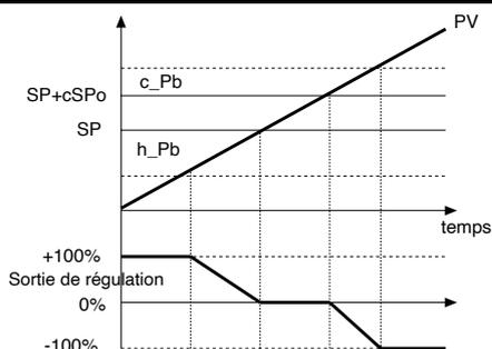
Sortie de régulation avec action proportionnelle seulement en cas de bande proportionnelle de chauffage séparée de celle de refroidissement
