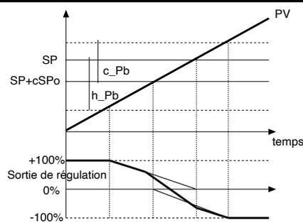
Sortie de régulation avec action proportionnelle seulement en cas de bande proportionnelle de chauffage superposée à celle de refroidissement
