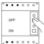
**Obs.:** se a instalação for mista, incluindo algumas unidades que não são testadas automaticamente, aguarde 3 segundos e em seguida pressione OFF.
