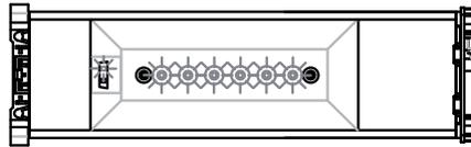
**FR** Mettre sous tension. Le voyant SATI vert clignote durant 28h. 6 diodes centrales allumées à faible puissance.
