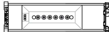
**FR** Le bloc peut être mis au repos ou rallumé par action sur les poussoirs ALLUMAGE et EXTINCTION du coffret de télécommande 039 01. Au retour du secteur le bloc se remet en veille après 30 secondes..
