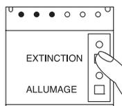
**Note:** dans le cas d'une installation panachée ayant certains blocs non testables automatiquement, attendre 3 secondes puis terminer par une impulsion sur EXTINCTION. Tous les blocs sont en veille. Les blocs à test automatique seront testés à l'heure choisie (le jour sera différent suivant les blocs).
