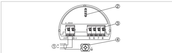
Compartiment électronique et de raccordement boîtier à chambre unique
