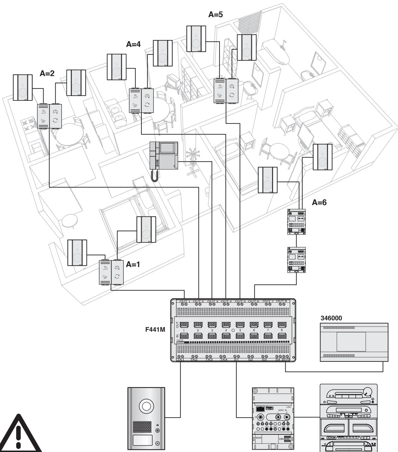
Gli amplificatori collegati ad ogni uscita OUT della matrice multicanale F441M devono essere configurati con indirizzo di ambiente A uguale al numero dell'uscita (es. OUT1-A=1, OUT2-A=2). Le sorgenti collegate agli ingressi S devono essere configurate con indirizzo di sorgente S uguale al numero dell'ingresso utilizzato (es. S1-S=1, S2-S=2)
