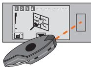
Dans le cas d'alarme technique (le symbole correspondant apparaît), on peut connaître le dispositif qui a généré l'alarme et aussi le remettre à zéro.
