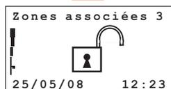
Confirmer la sélection en utilisant le code utilisateur, une clé transpondeur ou un code numérique
