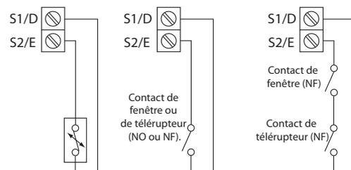
Configuration pour capteur d'ambiance à distance ou pour capteur de limite
