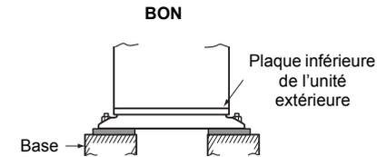
Soutien de la surface inférieure de la patte de fixation qui est en contact avec et dessous la plaque inférieure de l'unité extérieure.
