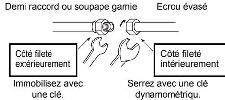
2. Comme illustré sur la figure, assurez-vous d'utiliser deux clés pour desserrer ou serrer l'écrou évasé de la soupape sur le côté gaz. Si vous utilisez une seule clé à molette, vous ne pouvez pas serrer l'écrou évasé au couple requis. D'autre part, utilisez une seule clé à molette pour desserrer ou serrer l'écrou évasé de la soupape sur le côté liquide.
