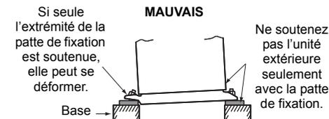
Réglez la marge extérieure du boulon d'ancrage sur 15 mm ou moins.
