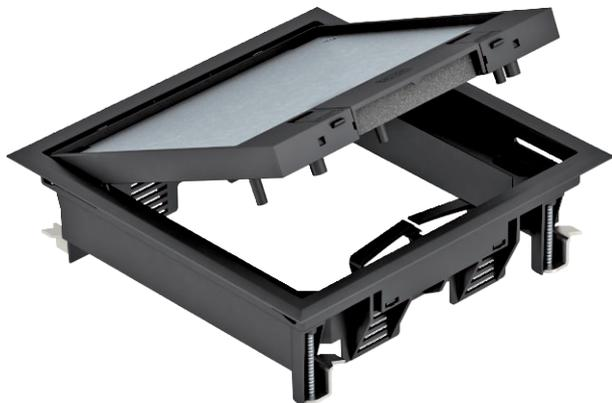
Boîtier de sol avec coulisseau d'arrêt pour 6 appareillages individuels Modul 45 maximum sur 2 supports universels UT3, insertion dans les systèmes de conduits et dans les faux planchers. Évidement prédéfini de 5 mm pour l'insertion du revêtement de sol dans le couvercle rabattable, réglage possible sur 3, 8 ou 10 mm si nécessaire.
