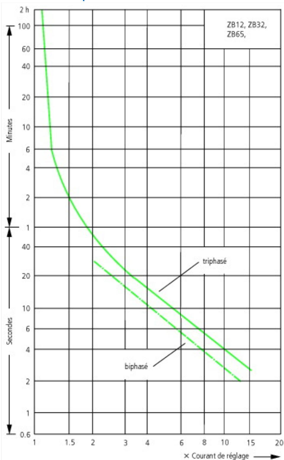
Ces courbes de déclenchement correspondent à des valeurs moyennes des propagations à une température ambiante de 20 °C à froid.
