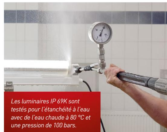
*Les luminaires IP 69K sont testés pour l'étanchéité à l'eau avec de l'eau chaude à 80 °C et une pression de 100 bars.*
