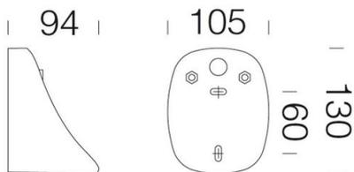
en nylon chargé en f.v. pour une installation directe sur mur ou au plafonnier.
