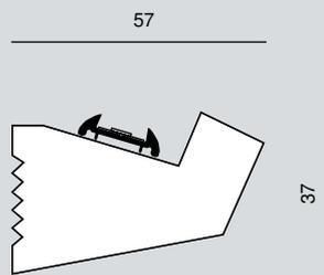
Profilé mini corniche en plâtre haute densité pour éclairage indirect.
