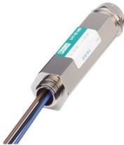
Parafoudre basse tension dans module à visser IP67 pour capteur de mesure, montage direct avec filetage extérieur 3/4" NPT, presse-étoupe pour ligne de signaux, circuit de protection à deux niveaux. Compatible HART. Utilisable dans des circuits sécurisés jusqu'à la catégorie SIL 3.
