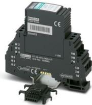
Parafoudre basse tension, consistant en une fiche de protection et en un élément de base, avec indicateur d'état à plusieurs niveaux intégré sur le module pour quatre fils de signaux à potentiel de référence commun. Utilisable dans des circuits sécurisés jusqu'à la catégorie SIL 3.
