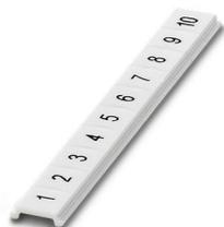
Ruban de repérage ZB, plat, Rubans, blanc, repéré, impression longitudinale: numérotation continue 1 ... 10, 11 ... 20, etc. jusqu'à 491 ... 500, type de montage: encliquetage, pour bloc de jonction au pas de : 5 mm, surface utile: 5,15 x 5,15 mm, Nombre d'étiquettes: 10
