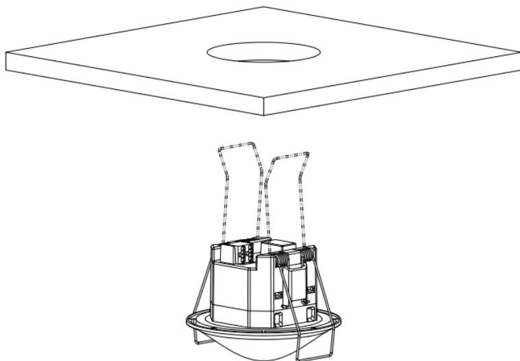
Montage dans des faux-plafonds d'une épaisseur de 0,5 mm à 3 cm. Le diamètre de la découpe au plafond doit être compris entre 62 mm et 70 mm. Le détecteur requiert une vue dégagée sur les personnes. La hauteur de montage ne doit pas être inférieure à 1,7 m, ni supérieure à 4 m.
