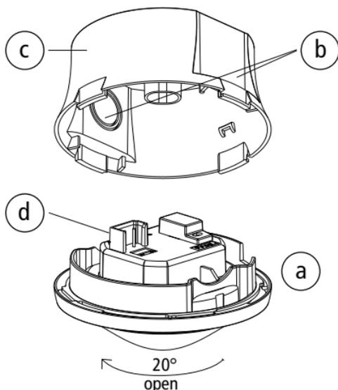
Tourner le capteur (a) d'environ 20° dans le sens anti-horaire jusqu'au point d'arrêt. Retirer le capteur. Effectuer les découpes nécessaires (b) pour le passage de câbles. Monter le boîtier en saillie (c) sur les orifices de fixation prévus au mur. Effectuer le câblage (d). Positionner le capteur (a).
