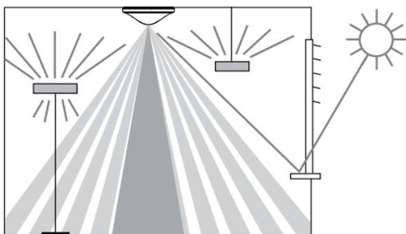
Le rayonnement direct influe sur la mesure de luminosité. Éviter de placer des lampadaires ou éclairages suspendus directement sous le détecteur.
