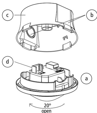
Tourner le capteur (a) d'environ 20° dans le sens anti-horaire jusqu'au point d'arrêt. Retirer le capteur. Effectuer les coupes nécessaires (b) pour le passage de câbles. Monter le boîtier en saillie (c) sur les orifices de fixation prévus au mur. Effectuer le câblage (d). Positionner le capteur (a).
