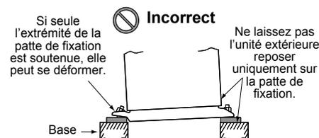
Réglez la marge extérieure du boulon d'ancrage sur 15 mm ou moins.
