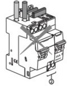
L'Interrupteur différentiel doit être protégé en amont, soit par un disjoncteur de branchement (ex. BACO), soit par un disjoncteur différentiel (ou un fusible gG) de même courant nominal que l'Interrupteur différentiel.
