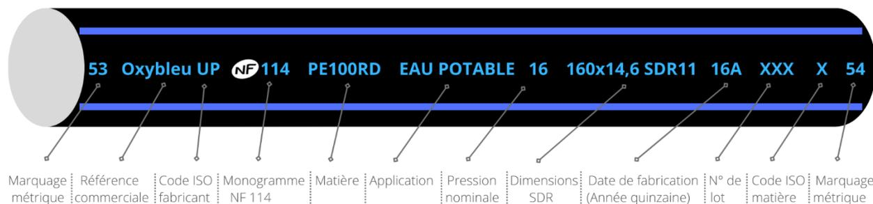
Contrairement à un tube uniquement conforme à la norme NF EN 12 201, un tube certifié à la Marque NF114 est fabriqué avec une matière 100% vierge de façon certaine et possède un marquage gravé à chaud sur le tube avec notamment les codes de traçabilité internationaux ISO du fabricant et de la matière première. L'interprétation de ces codes est disponible sur le site : [www.traccoding.com](http://www.traccoding.com).
