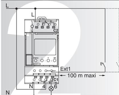
L'appareil est prévu pour être installé dans une armoire électrique sur rail DIN (selon EN 60715).
