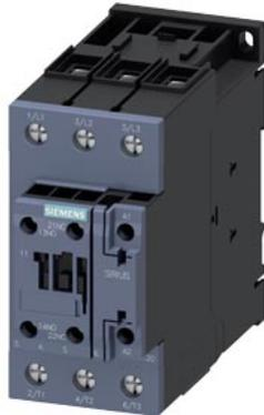
Contacteur de puissance, AC-3 65 A, 30 kW / 400 V 1 NO + 1 NF, CA / CC 20-33 V, avec varistance 3 pôles, taille S2 borne à vis
