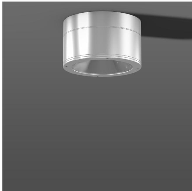
Downlight apparent de haute qualité. Boîtier en profilé d'aluminium extrudé, traité époxy. Anneau et plafonnier en aluminium injecté, traité époxy. Réflecteur en aluminium haute brillance anodisé. Avec verre de sécurité clair. Convient à Montage des plafonniers. Appareillage intégré. Avec borne de raccordement à 5 pôles. Boîtier d'alimentation avec possibilité de passage en coupure. Kit de suspension en accessoire.
