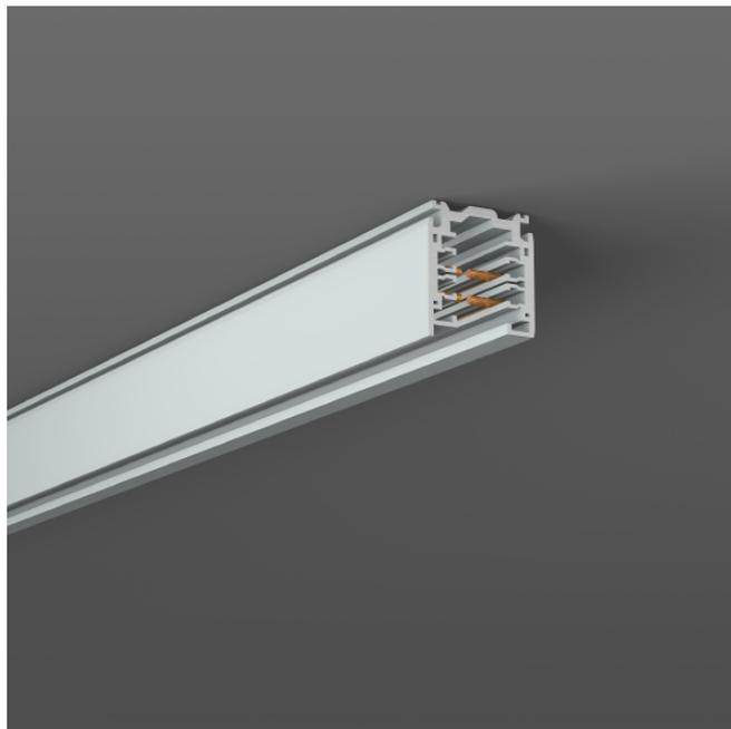
Extrudé aluminium profilé laqué, rails pouvant être raccourcis à volonté, manipulation sans risques, avec câble DALI 2 pôles supplémentaire intégré, câble d'alimentation 16 A / 400 V, ligne pilote DALI 2 x 1 A / 50 V FELV AC.
