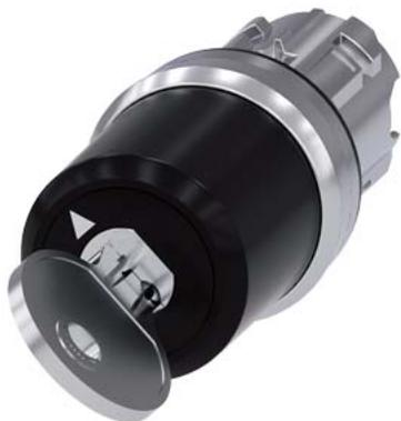
Commutateur à clé BKS, 22 mm, rond, métal, brillant, serrure spéciale, avec 2 clés, 2 positions de commutation O-I, à accrochage, angle de manœuvre 90°, 10h30/13h30, Retrait de la clé O, remarque : pour les serrures BKS E1 - E25 livraison sans clé
