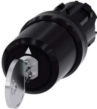
Commutateur à clé BKS, 22 mm, rond, plastique, N° de serrure E2 (VW), sans clé, 3 positions de commutation I-O-II, à accrochage, Angle de manœuvre 2x45°, 10h30/12h/13h30, Retrait de la clé I+O+II, avec marquage laser minuscules
