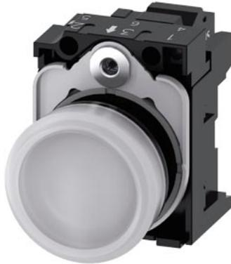
voyant lumineux, 22 mm, rond, plastique, blanc, lentille, lisse, avec support, Module LED, avec LED intégrée 230 V CA Borne à ressort, Z= colisage de 20 pièces
