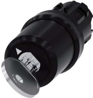
Commutateur à clé BKS, 22 mm, rond, plastique, N° de serrure S1, avec 2 clés, 2 positions de commutation O-I, à accrochage, Angle de manœuvre 90°, 10h30/13h30, Retrait de la clé I, avec marquage laser Majuscules et minuscules, Début de ligne toujours en majuscules
