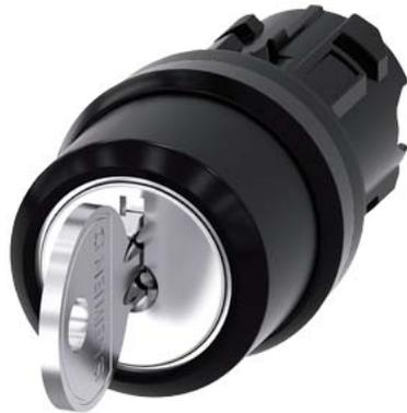
Commutateur à clé RONIS, 22 mm, rond, plastique, N° de serrure SB30 avec 2 clés, 3 positions de commutation I-O-II, à accrochage, Angle de manœuvre 2x45°, 10h30/12h/13h30, Retrait de la clé I+O+II, serrures spéciales : SB31, 421, 455, avec marquage laser Majuscules et minuscules, Début de ligne toujours en majuscules
