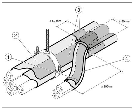
Figure 6 : Entrées et sorties de câble
