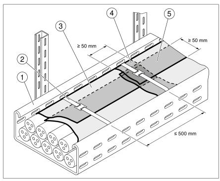
Figure 2 : Enrubannage Coupe-Feu dans un chemin de câbles
