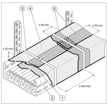
Figure 4 : Enrubannage Coupe-Feu autour d'un chemin de câbles
