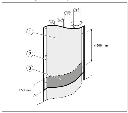
Figure 1 : Pose murale et au plafond de l'enrubannage coupe-feu
