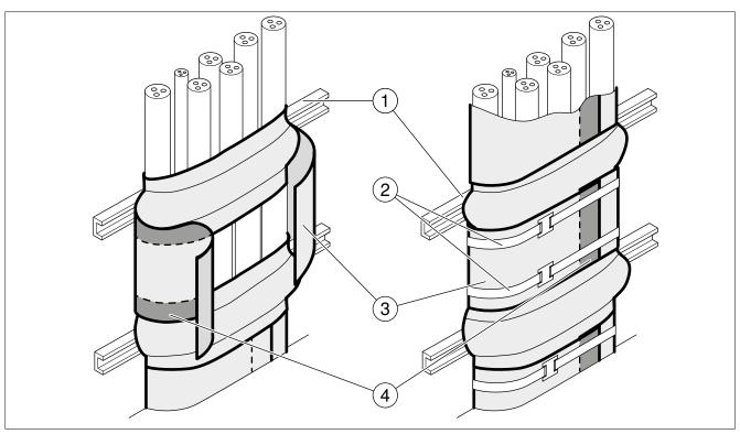
Figure 5 : Enrubannage coupe-feu autour d'une échelle à câbles
