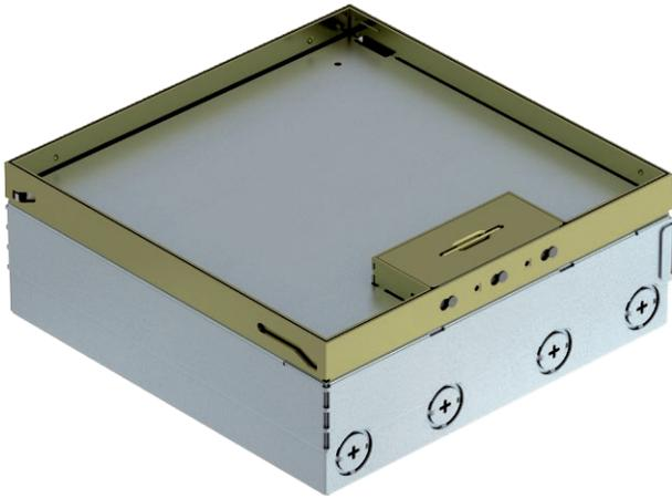
Boitier de sol carré complet pour une utilisation dans des planchers creux et des chapes nettoyés à sec. Corps du boitier avec ouvertures prédécoupées pour tubes (M25). Partie supérieure réglable à l'aide de 4 supports de nivellement sur le rebord supérieur du revêtement de sol. La profondeur d'encastrement minimale est de 95 mm, la plage de réglage + 30 mm.
