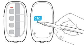
Die LEDs **cfg** sämtlicher Empfänger und des Senders erlöschen. Ende der Konfiguration.
