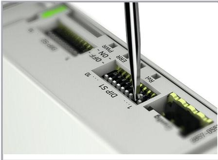
Configuration via micro-interrupteurs
