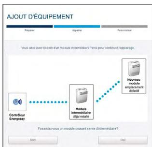
12.2. Cliquez sur « **Oui** » si votre installation comporte déjà un module appairé pouvant servir d'intermédiaire entre le contrôleur et le nouveau module à installer.
