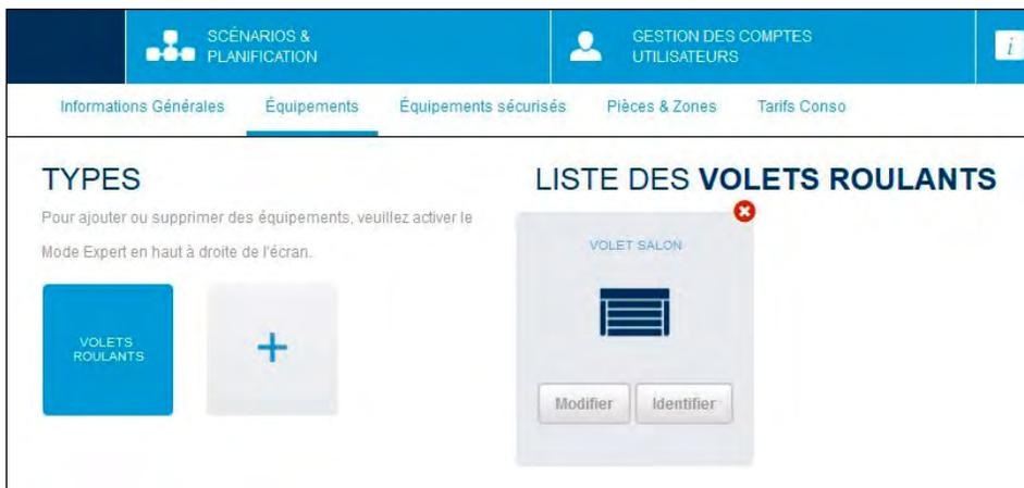
**Félicitations !** Le micromodule volet roulant radio est bien appairé au contrôleur **energeasyconnect**. Pour appairer les autres micromodules volets roulants, répétez pour chacun des modules l'ensemble des actions de l'étape **3. Installation du micromodule** et **4. Appairage du micromodule** de cette notice.
