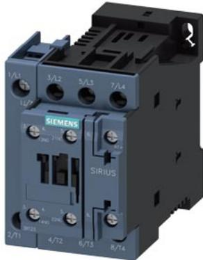
Contacteur, AC-3, 32 A/15 kW/400 V, S0, 4 pôles, 24V CC, 1 NO +1 NF, borne à vis
