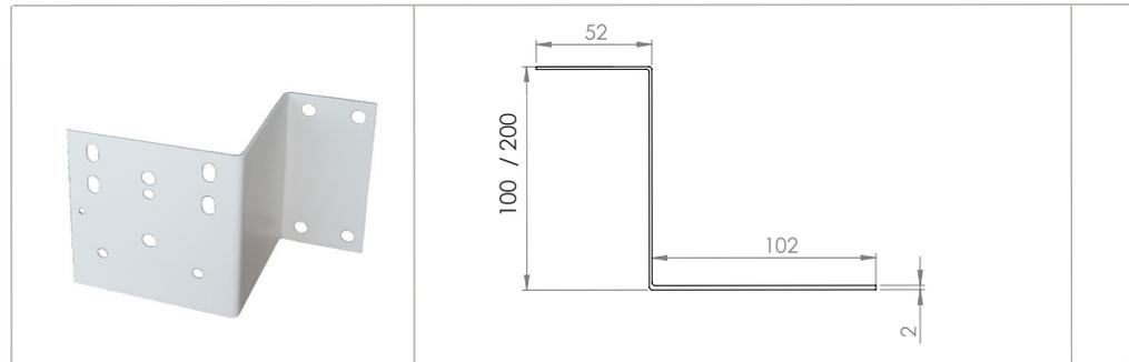
**PATTES D'ÉCARTEMENT** pour un déport du mur de 10 ou 20 cm : Une paire jusqu'à 300cm de base et un trio pour le modèle en 350cm de base
