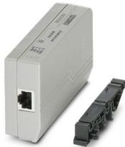
Parafoudre basse tension pour réseaux de données jusqu'à 1 Gbit/s. Utilisation dans Ethernet, Power over Ethernet (PoE, Mode A et Mode B), Token Ring, ISDN et DS1. Adaptateur RJ45 avec conducteur de terre distinct et pied encliquetable pour rails DIN NS 35.
