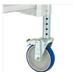
Roues Ø 150 mm réglage individuel tous les 25 mm sur 125 mm
