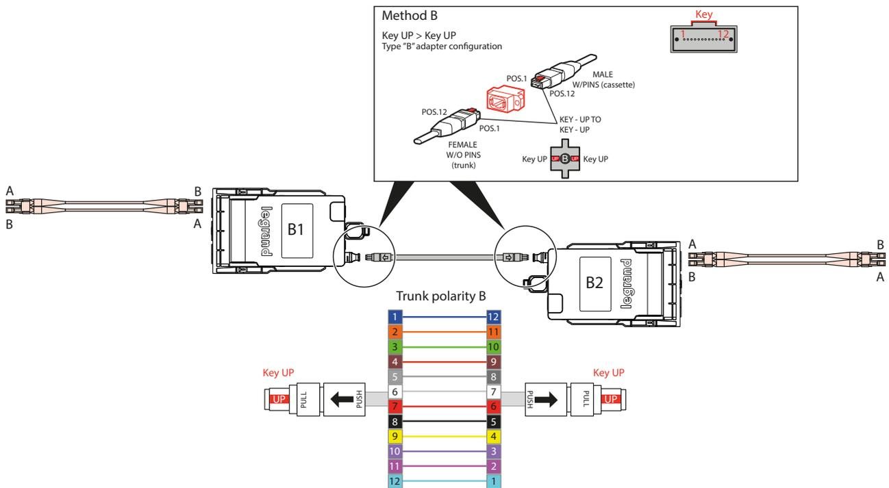
Pour les cassettes monomode en polarité B (traversée en « key-up/key-up »), le connecteur MTP mâle de la cassettes est « up-angled » selon l'IEC 61754-1-12 et donc seulement compatible avec des trunks MTP (ou MPO) femelle polarité B standards (« down-angled »). Trunks polarité B disponibles à la demande.
