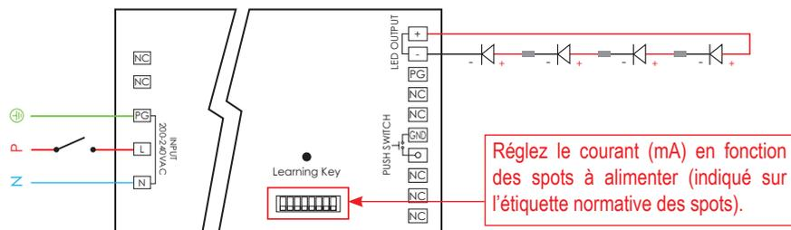
Raccorder vos spots en série sur l'entrée secondaire du convertisseur (LED OUTPUT + et -), puis raccorder le Neutre (N), la Phase (L) et la Terre (T), l'interrupteur ouvre le circuit de la Phase.
