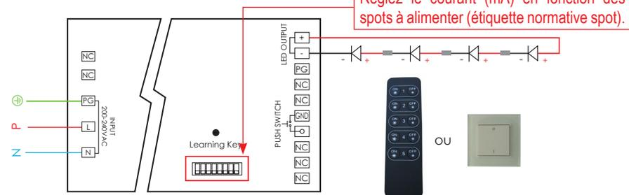
Raccorder vos spots en série sur l'entrée secondaire du convertisseur (LED OUTPUT + et -), puis raccorder le Neutre (N), la Phase (L) et la Terre (T).
