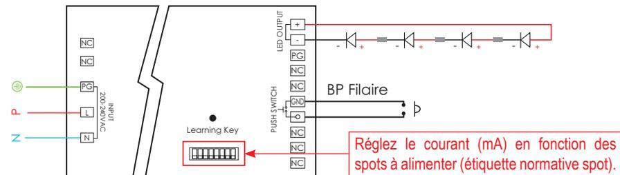
Raccorder vos spots en série sur l'entrée secondaire du convertisseur (LED OUTPUT + et -), puis raccorder le Bouton Poussoir filaire entre les 2 entrées **PUSH SWITCH**. Raccorder le Neutre (N), la Phase (L) et la Terre (T). Faire un appui court sur le BP pour allumer et éteindre le circuit, un appui long pour faire varier l'intensité lumineuse.
