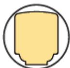
Diamètre intérieur minimum du candélabre : 68 mm
