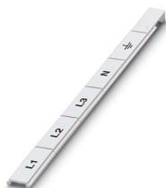
Repères pour blocs de jonction, Rubans, blanc, repéré, longitudinal: L1, L2, L3, N, GND, type de montage: encliquetage, pour bloc de jonction au pas de : 18 mm, surface utile: 18 x 5 mm, Nombre d'étiquettes: 5
