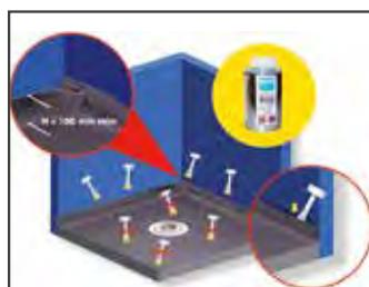
**3** Positionner le film proprement, faire remonter les bords sur 3 à 4 cm au dessus de la hauteur de chape prévue, effectuer un pli mouchoir dans les angles. Coller seulement les bords du film au mur et le pli mouchoir.
