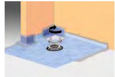
**14** Positionner les joints si nécessaire (cf schéma ci-dessous). Visser le support de grille. Avec bonde verticale : *ne pas ajouter les joints.*
