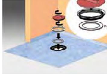
**10** Visser la couronne fileté de bonde dans celle du panneau PSE Haute Densité avec la clé de serrage qui sert de cache anti-débris.
