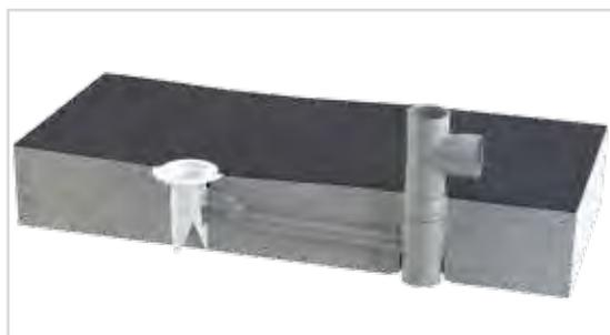
**11** Positionner la sous couche acoustique au ras de la collerette d'étanchéité du siphon.
