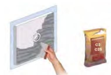
**20** Positionner les joints si nécessaires (cf schéma ci-dessous). Visser le support de grille. Avec bonde verticale : *ne pas ajouter les joints.*
