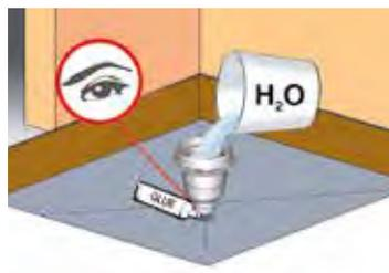
4 Raccorder la bonde à la canalisation d'évacuation principale à l'aide d'un tube PVC à coller. Vérifier l'étanchéité du raccordement en versant de l'eau dans la bonde.
