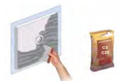
**17** Positionner les joints si nécessaire (cf schéma ci-dessous). Visser le support de grille. Avec bonde verticale : *ne pas ajouter les joints.*
