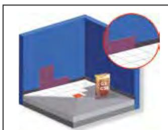
**6** Poser le carrelage à l'aide d'une colle de type C2 ou C2S. Au niveau des changements de pente, faire des coupes carrelage en diagonal. Poser les carrelages muraux par dessus le film.
