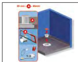
**4** En fonction de la hauteur A de chape à réaliser, couper si besoin le support au ras d'un anneau afin que A soit comprise entre 25 et 85 mm. Après la coupe, qui sera bien ébavurée, remonter le joint torique sur la dernière gorge du support. Mettre le support en position dans le corps de bonde, placer, le capot cache débris sur l'ensemble.
