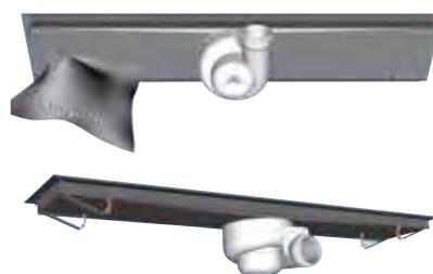
**9** Mettre le caniveau en place et positionner les pieds, sans enlever le film adhésif, de manière à ce qu'ils soient à proximité des pattes de scellement ; tracer au sol la position des embases.
