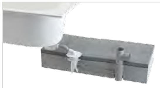
**12** Positionner la réhausse et couler la chape avec une forme de pente de 1 % minimum.
