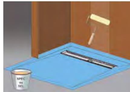
**14** Appliquer un primaire d'étanchéité style SPEC ou SEL sur les surfaces en contact avec l'eau, laisser sécher.
