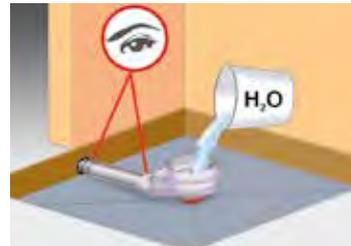
5 Couler la chape de ciment autour de la bonde et du tube de raccordement. Bien vérifier le niveau ainsi que la bonne hauteur de la chape au niveau de la bonde. (cf. croquis)
