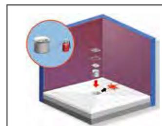
**7** Enlever le cache débris puis mettre en place les éléments suivants comme indiqué : le siphon, la grille de retenue de cheveux, le réhausseur de grille, la grille.
