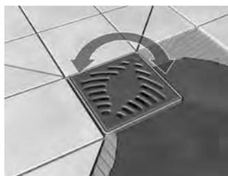
**6** Positionner le second film protecteur entre le cadre et la grille inox afin d'éviter les salissures pendant les travaux. L'ensemble grille + cadre + rehausse peut être orienté en fonction de l'alignement du carrelage.
