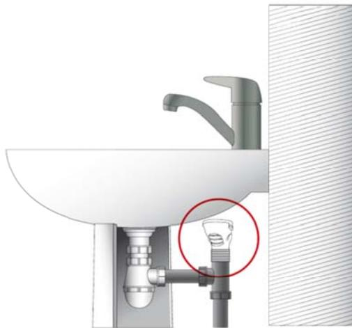
*Figure 7 - Exemple de positionnement de clapet équilibreur de pression CEP4050 ou CEP3240 sous lavabo*
