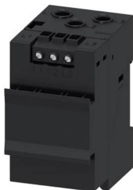
Module de détection de courant / tension V2 ; courant de réglage 3...40 A, mesure de la tension jusqu'à 690 V, largeur 45mm, transformateur à primaire traversant, requiert un appareil de base pro V PB, pro V MR, pro V PN ou pro V EIP
