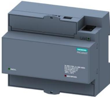
SETRON, Appareil de mesure, 7KM PAC3200T, pour rail DIN sans écran, L-L: 400 V, L-N: 230 V, 5 A, rail DIN, triphasé, Modbus TCP, Énergie apparente / active / réactive, bloc d'alimentation à large plage de tension CA/CC, Borne à vis
