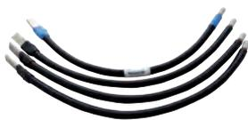
Ce kit de 4 liaisons 95<sup>2</sup> permet le raccordement direct entre les borniers du distributeur 400 A MICHAUD et les bornes entrée de SPCM Réf. Q950. Chaque liaison, d'une longueur de 58 cm, présente en son extrémité une douille de diamètre 13,5 mm et de longueur 30 mm. Chaque kit est livré avec une boîte à câble.
